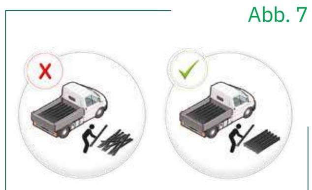
Es wird empfohlen, die Rohre und Formstücke in ihren Original-Verkaufsverpackungen zu belassen, um diese zu schützen und Beschädigungen durch Verladung und Transport zu vermeiden.
